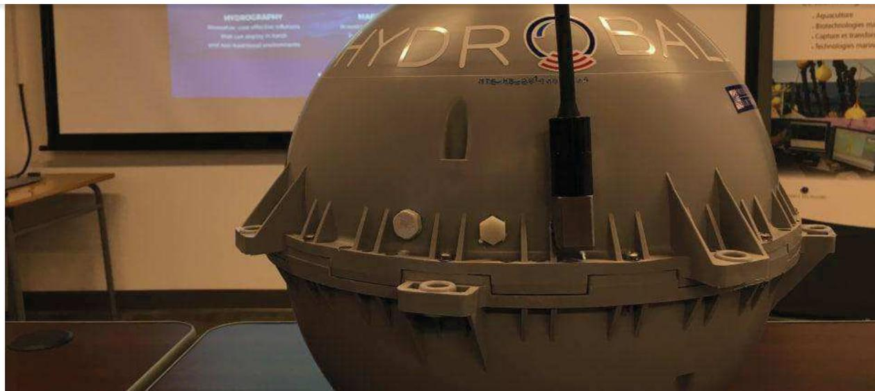
L'HydroBall, la bouée développée à Rimouski par le Centre interdisciplinaire de développement en cartographie des océans (CIDCO). Elle permet de cartographier les fonds marins. Photo : Radio-Canada
